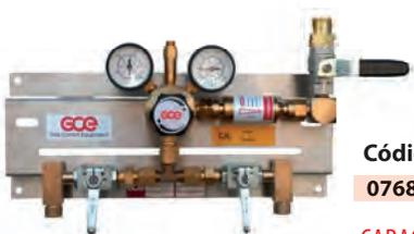
Variante de acetileno de la central de cambio manual MM70-2 para servicio con cilindro. Se ha diseñado y fabricado de conformidad con ISO 14 114. Consta de válvulas de cierre manual de acción rápida en cada lado aguas arriba del regulador. Estos dispositivos se comprueban de conformidad con ISO 15 615. La central incluye un anti retroceso de llama F 90 (EN 730-1, ISO 5175), y una válvula de bola de salida, montado aguas abajo del regulador.
